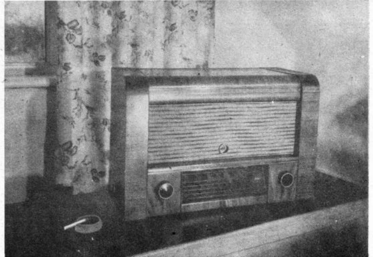
Bild 3. Der formschöne Großsuper 9 R81 von Stern-Radio mit mehreren KW-Bereichen und mit „Magischem Auge“
