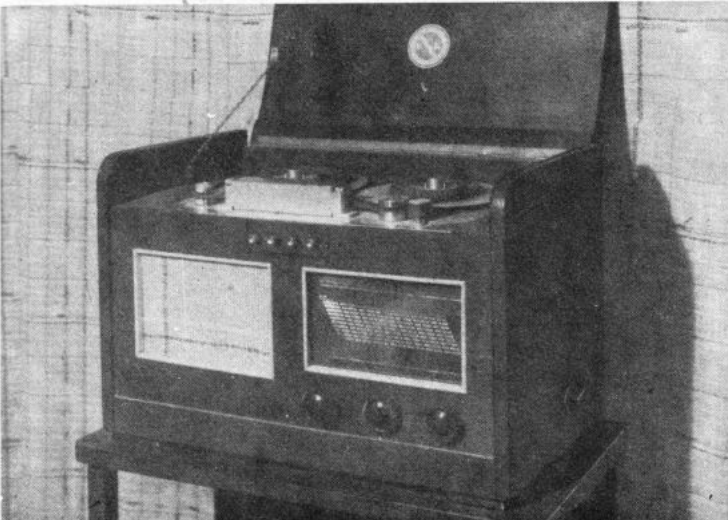
Bild 2. Was sich jeder Rundfunkliebhaber wünscht: Magneton mit Rundfunkgerät kombiniert
