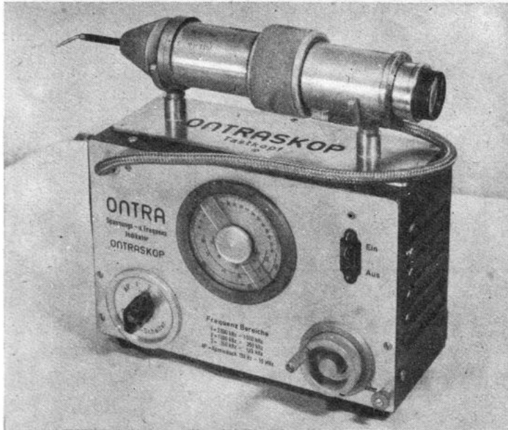
Bild 1. Spannungs- und Frequenz-Indikator „Ontraskop“
